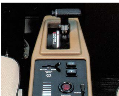
Система K-ATOMiCS (модернизированная коробка передач Комацу с системой оптимального управления модуляцией)
